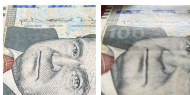
Sistema de impresión en Intaglio Billete Peruano 100 Soles
